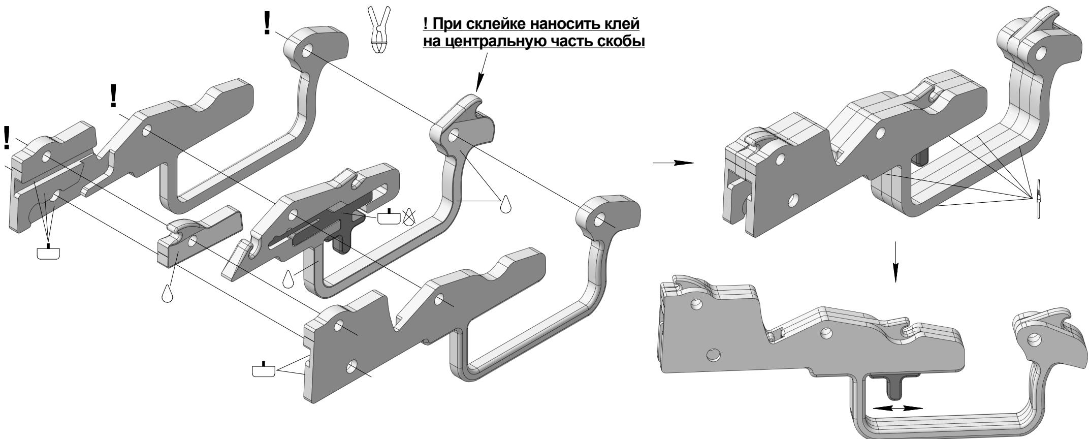
Чтобы выровнять склеиваемые детали, вставьте шкант или стяжку в отверстие. **Следите, чтобы клей не попадал на шкант или стяжку.** После высыхания клея, шкант или стяжка должны легко выниматься. Тщательно обработайте кромки деталей. От качества скругления зависит срок службы резинок.
