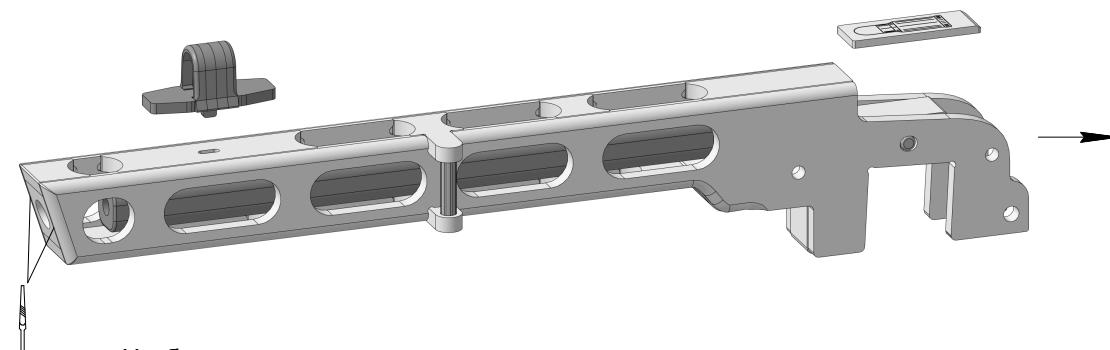
**!** Чтобы выровнять склеиваемые детали, вставьте шкант или стяжку в отверстие. **Следите, чтобы клей не попадал на шкант или стяжку.** После высыхания клея, шкант или стяжка должны легко выниматься. Тщательно обработайте кромки деталей.
