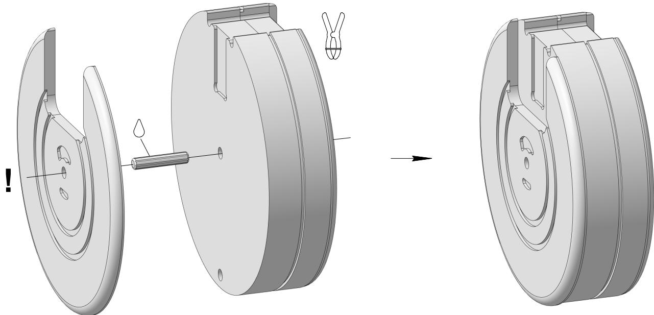
! Чтобы выровнять склеиваемые детали, вставьте шкант или стяжку в отверстие. Следите, чтобы клей не попадал на шкант или стяжку. После высыхания клея, шкант или стяжка должны легко выниматься.
