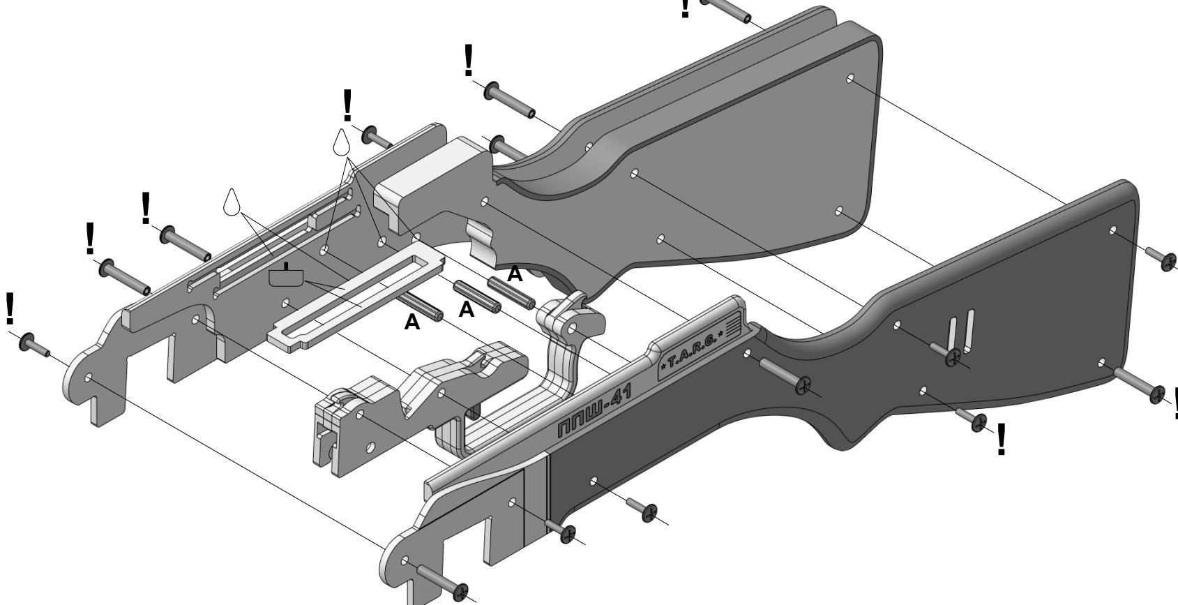
! Чтобы выровнять склеиваемые детали, вставьте шкант или стяжку в отверстие. **Следите, чтобы клей не попадал на шкант или стяжку.** После высыхания клея, шкант или стяжка должны легко выниматься. Приклейте шканты и детали только к правой боковой накладке. Собрать корпус без механизма, подождать пока высохнет клей. Затем разобрать и собрать уже с механизмом. Нанесите парафин для смазки.
