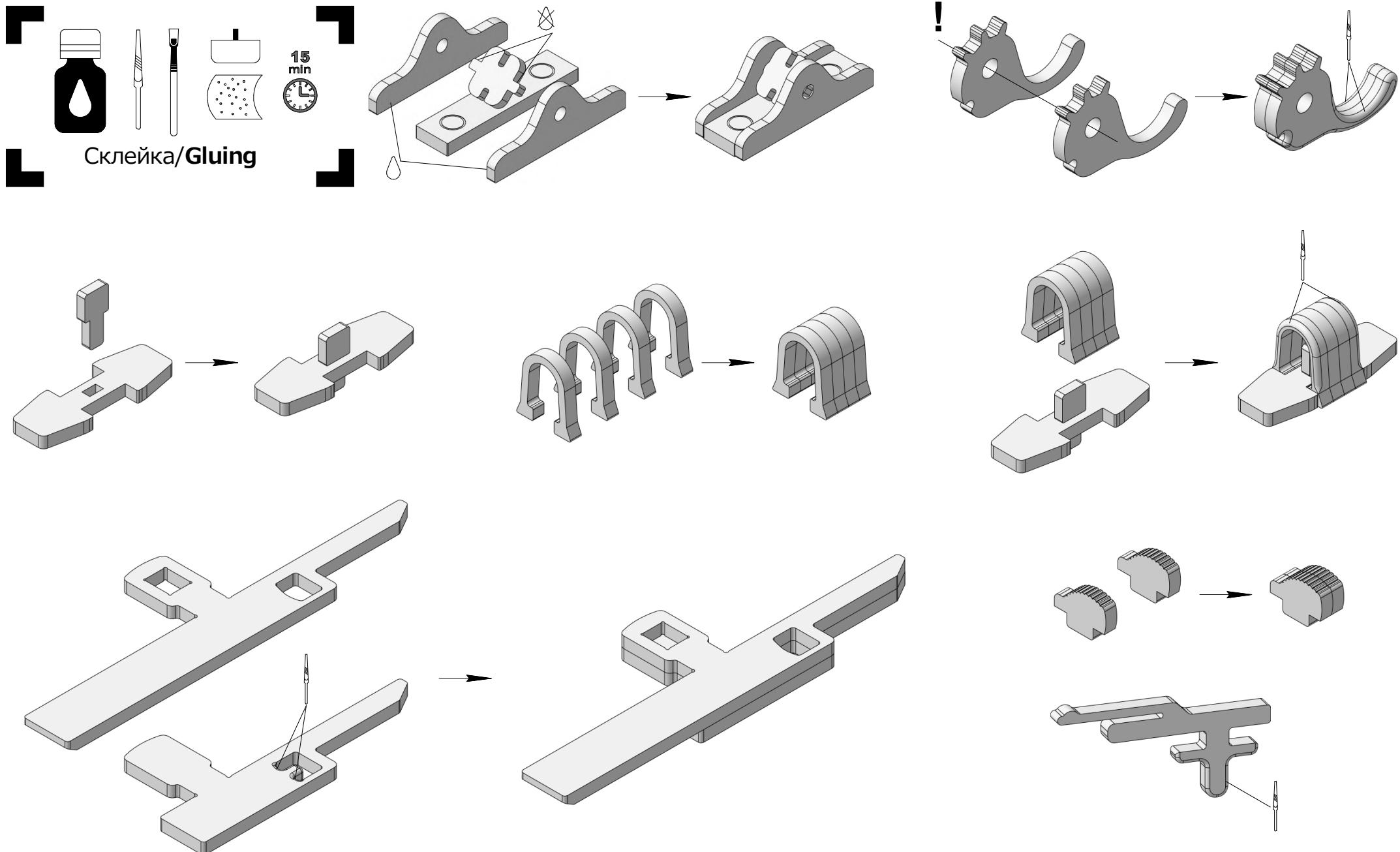
! Чтобы выровнять склеиваемые детали, вставьте шкант или стяжку в отверстие. **Следите, чтобы клей не попадал на шкант или стяжку.** После высыхания клея, шкант или стяжка должны легко выниматься. Тщательно обработайте кромки деталей. От качества скругления зависит срок службы резинок.
